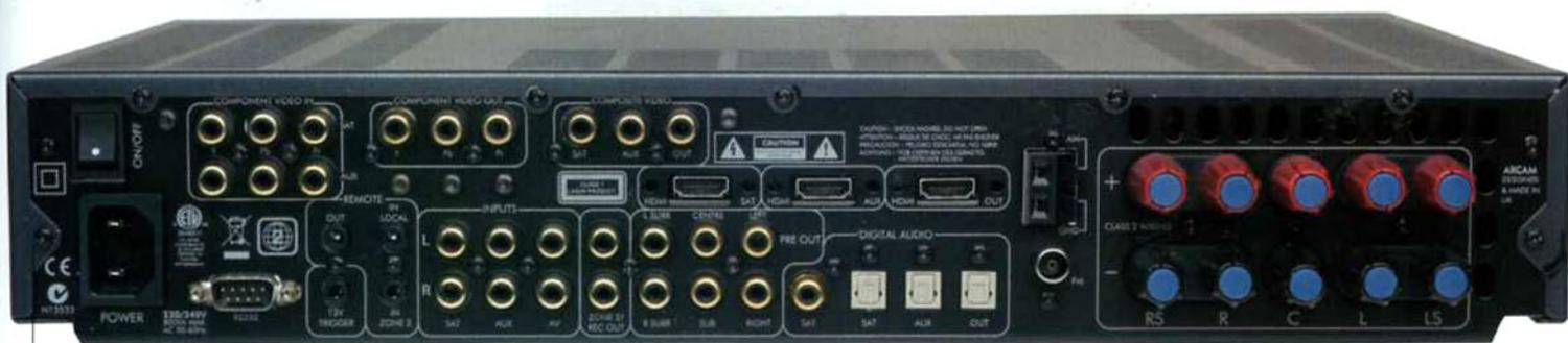
■ **CONNESSIONI DI QUALITÀ** - La versione europea del Solo Movie 5.1 rinuncia alle uscite component, presenti in quella americana, a favore di tre SCART anche RGB, più indicate per facilitare l'approccio alla complessità dell'apparecchio da parte di un pubblico più vasto. Non mancano una presa di rete ad uso dell'assistenza, un set completo di prese
